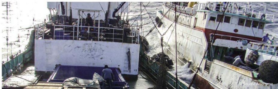
Ci-dessus : palangrier en cours de transbordement vers un navire transporteur en mer. L'utilisation de pare-battages Yokohama peut être observée.
